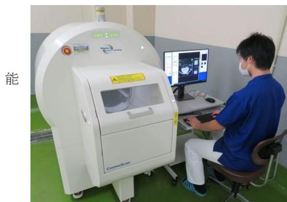
※最速 18 秒の高速撮影、最小画素サイズ 60  $\mu\text{m}$  の高解像度撮影および最大撮影範囲 220 mm の広視野撮影が可能
